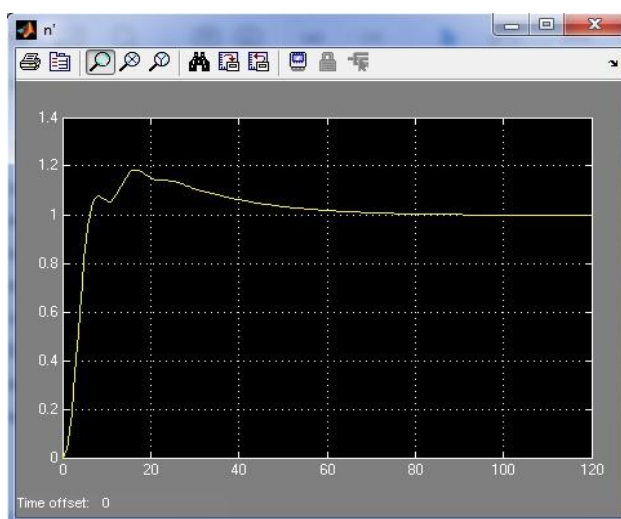
Рисунок 4 - Графики переходных процессов с ПИ-регулятором в САУ ГТД
